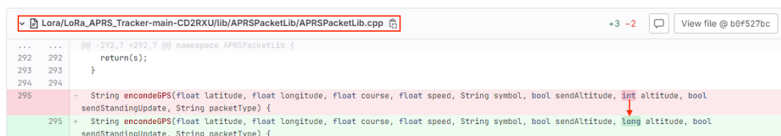
Figure 4 – Modification dans la fonction "encodeGPS"
