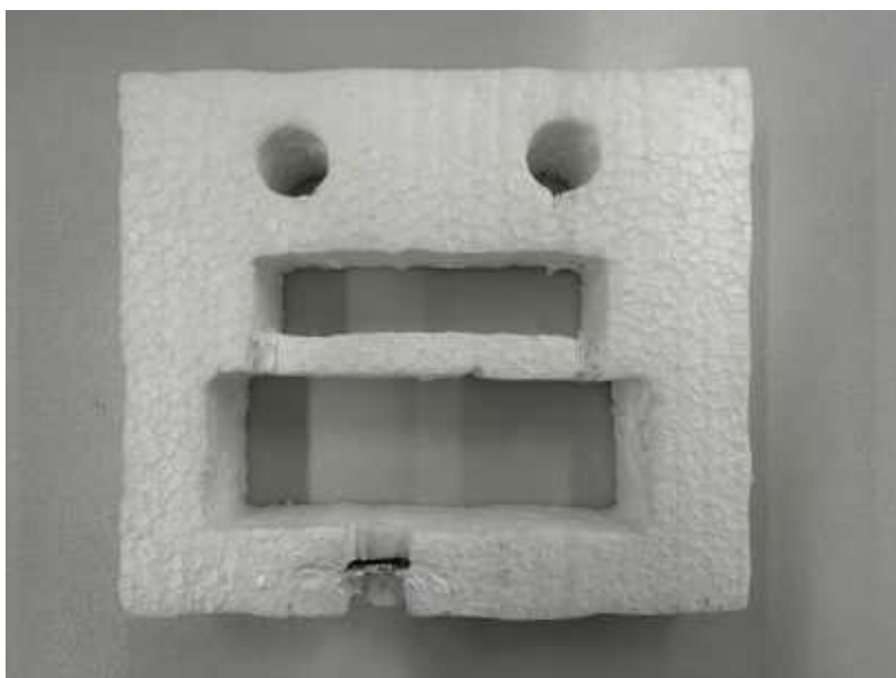
Figure 21 – Partie centrale de la sonde APRS
